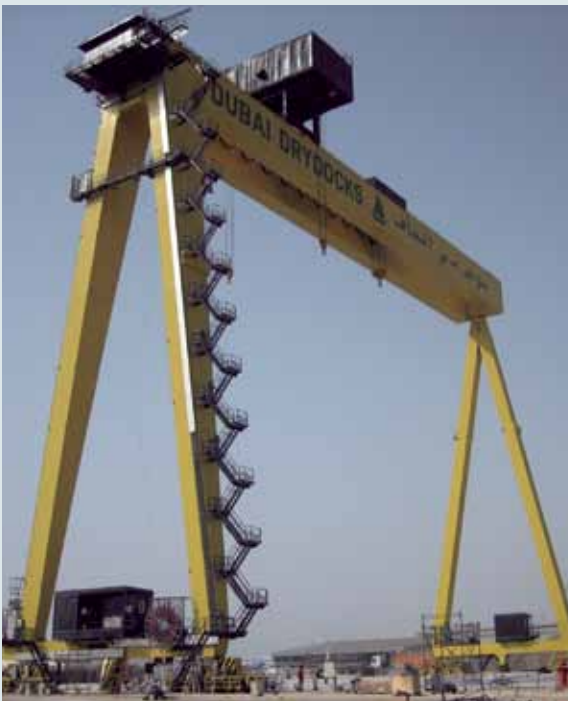
Double girder construction 300 t / 70 m, U.A.E.
