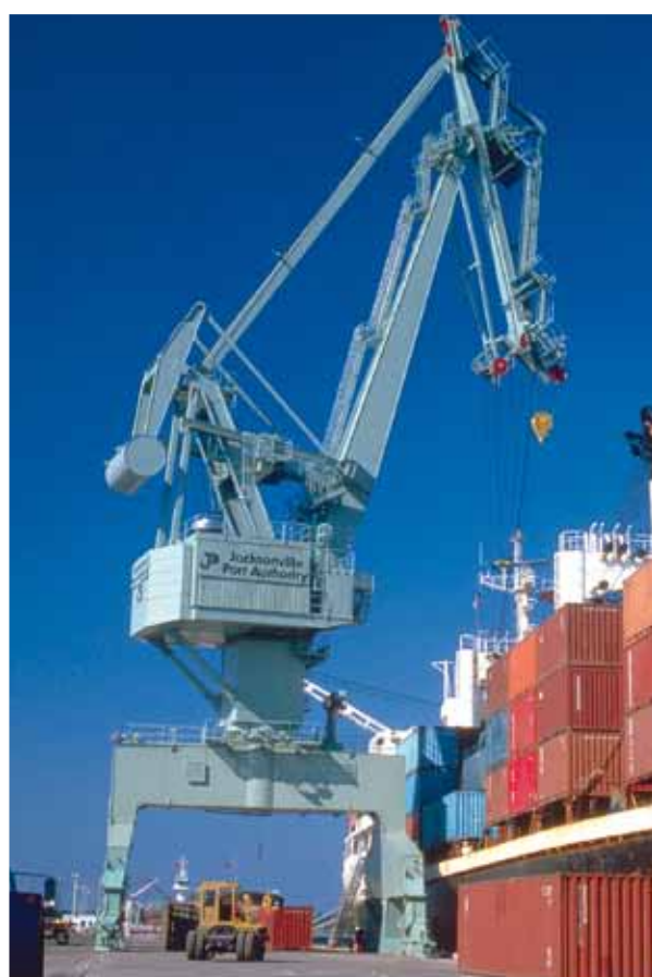
Spreader 40 ton / Hook 100 ton, Outreach 36,6 m
