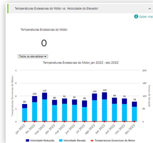
O gráfico mostra a relação de funcionamento entre a baixa e alta velocidade de um motor de 2 velocidades e o número de episódios de excesso de temperatura no mesmo período.
